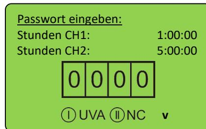
Auf diesem Bildschirm sehen Sie die Betriebsstunden für jeden Kanal. Das Format ist Stunden:Minuten:Sekunden.
