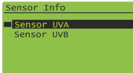
Wählen Sie den Sensor aus. Informationen über den Sensor werden angezeigt. Wenn kein Sensor angeschlossen ist, wird dieser Menüpunkt nicht angezeigt.
