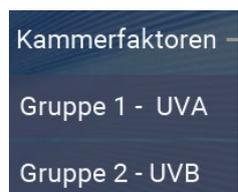
Der Kammerfaktor wird verwendet, um die Bestrahlungsstärke an einer anderen Position (als an der Sensorposition) zu berechnen und auszugeben.
