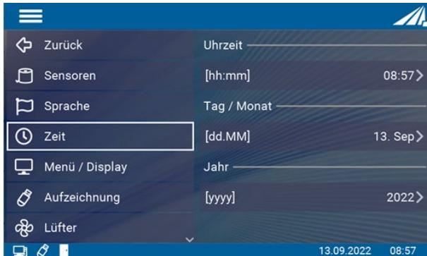
Die Echtzeituhr wird automatisch durch Verbinden des Geräts mit der PC Software gestellt oder kann in dem Menü Zeit eingestellt werden. Das Einstellen der Uhrzeit kann z.B. nach einem Firmwareupdate oder nach dem Zurücksetzen auf Werkseinstellungen nötig sein.
