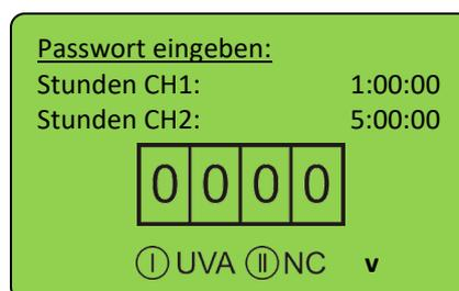
Auch ohne PIN werden die Betriebsstunden, die angeschlossenen Sensoren und die Firmware-Version angezeigt. Nach Eingabe der PIN und Bestätigung mit OK können Sie die Systemeinstellungen ändern:
