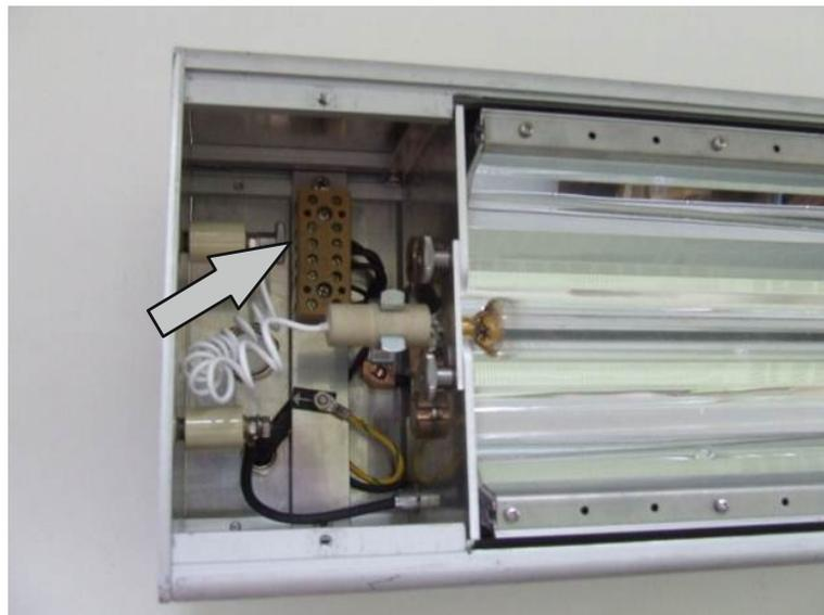
24. Lösen Sie die Rändelmutter der Sicherungsbügel und klappen Sie diesen weg.
