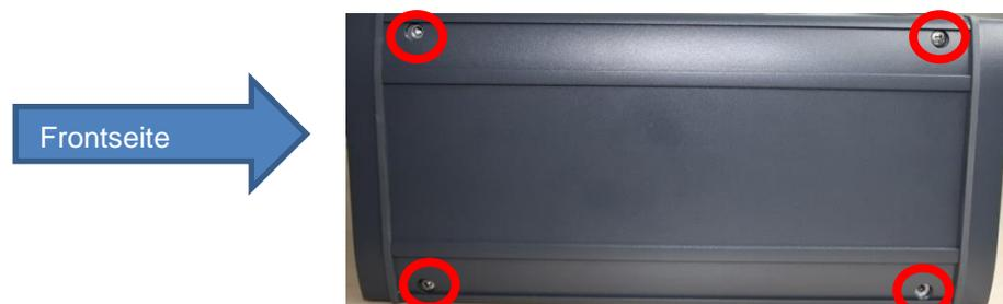
4. Nehmen Sie die Gehäusewand ab. Jetzt ist die Lampe im Lampenhalter sichtbar.
