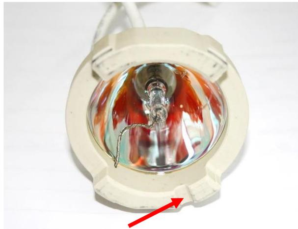
11. Setzen Sie die neue Lampe hinten zuerst in den Halter. Führen Sie hierzu den Lampenkolben zuerst zwischen dem Aluminiumblock und dem hinteren, weißen Halter.
