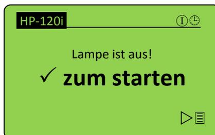
Im Statusbildschirm werden der Lampenstatus, die interne oder externe Steuerung und Fehlermeldungen angezeigt. In der oberen, rechten Ecke wird der Zustand angezeigt, hierbei bedeuten:
