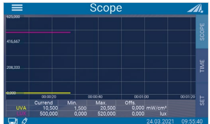
Zeitverlauf der Bestrahlungsstärke (Scope Mode)
