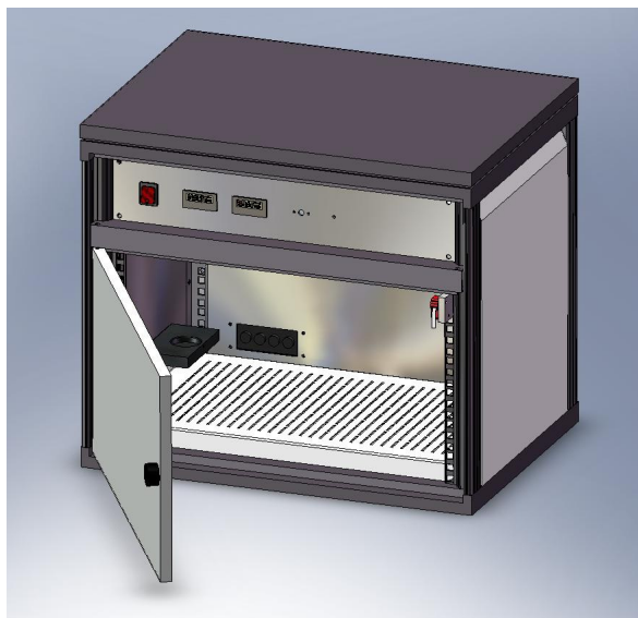
Abb. 1: Konstruktionszeichnung der UV/VIS-Bestrahlungskammer BS-02
