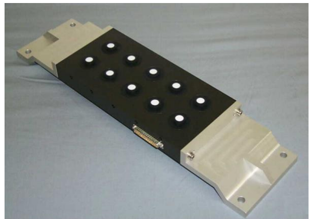
Abb. 4: Sensorplatte mit 10 UV-Sensoren zur gleichzeitigen Kontrolle von 10 Lichtleitern
