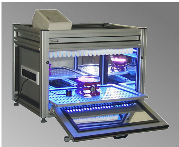
Abb. 1: UV/VIS-Bestrahlungskammer BS-03 mit Dosissteuerung UV-MAT
