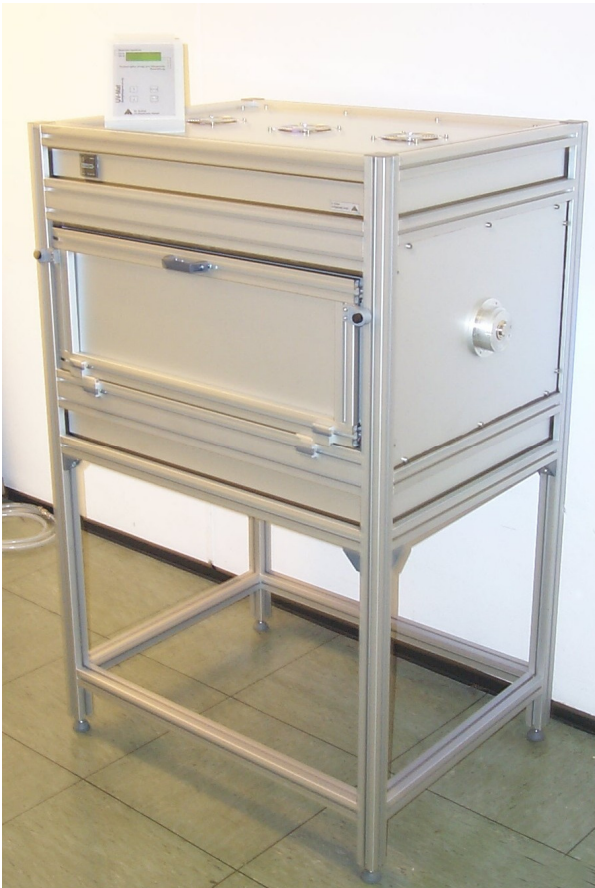
Abb. 1: UV/VIS-Bestrahlungskammer BS-05 mit Dosissteuerung UV-MAT
