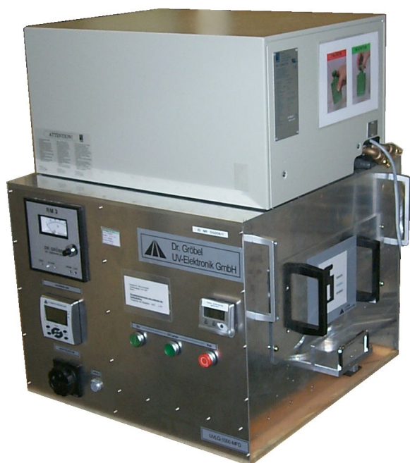
Abb. 1: UV/VIS-Bestrahlungskammer BS-08 mit Wasser-Luft-Kühler
